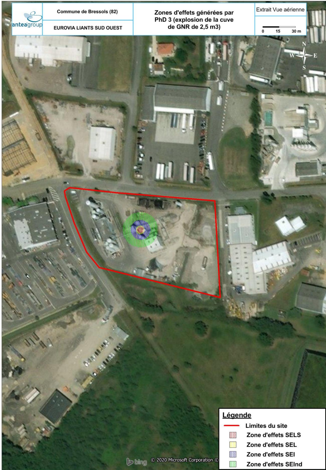
Figure 9. Cartographie des zones d'effets relatives à PhD 3 (explosion de la cuve de GNR)
