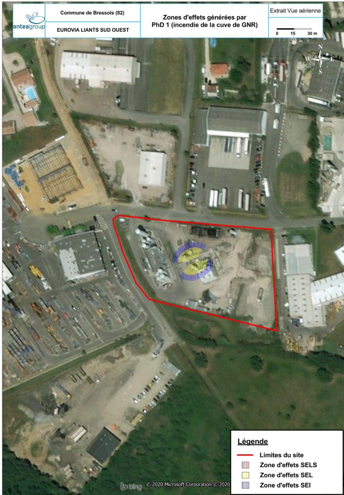
Figure 7. Cartographie des zones d'effets relatives à PhD 1 (incendie de la rétention de GNR)
