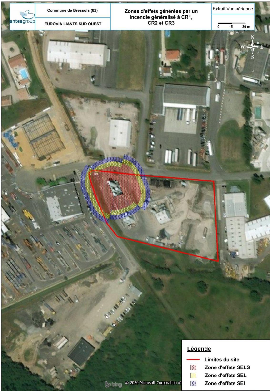
Figure 18. Cartographie des zones d'effets relatives à PhD 12 (incendie des rétentions CR1, CR2 et CR3)
