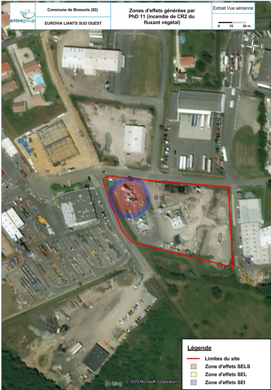
Figure 17. Cartographie des zones d'effets relatives à PhD 11 (incendie de la rétention CR2 de la cuve de fluxant végétal)
