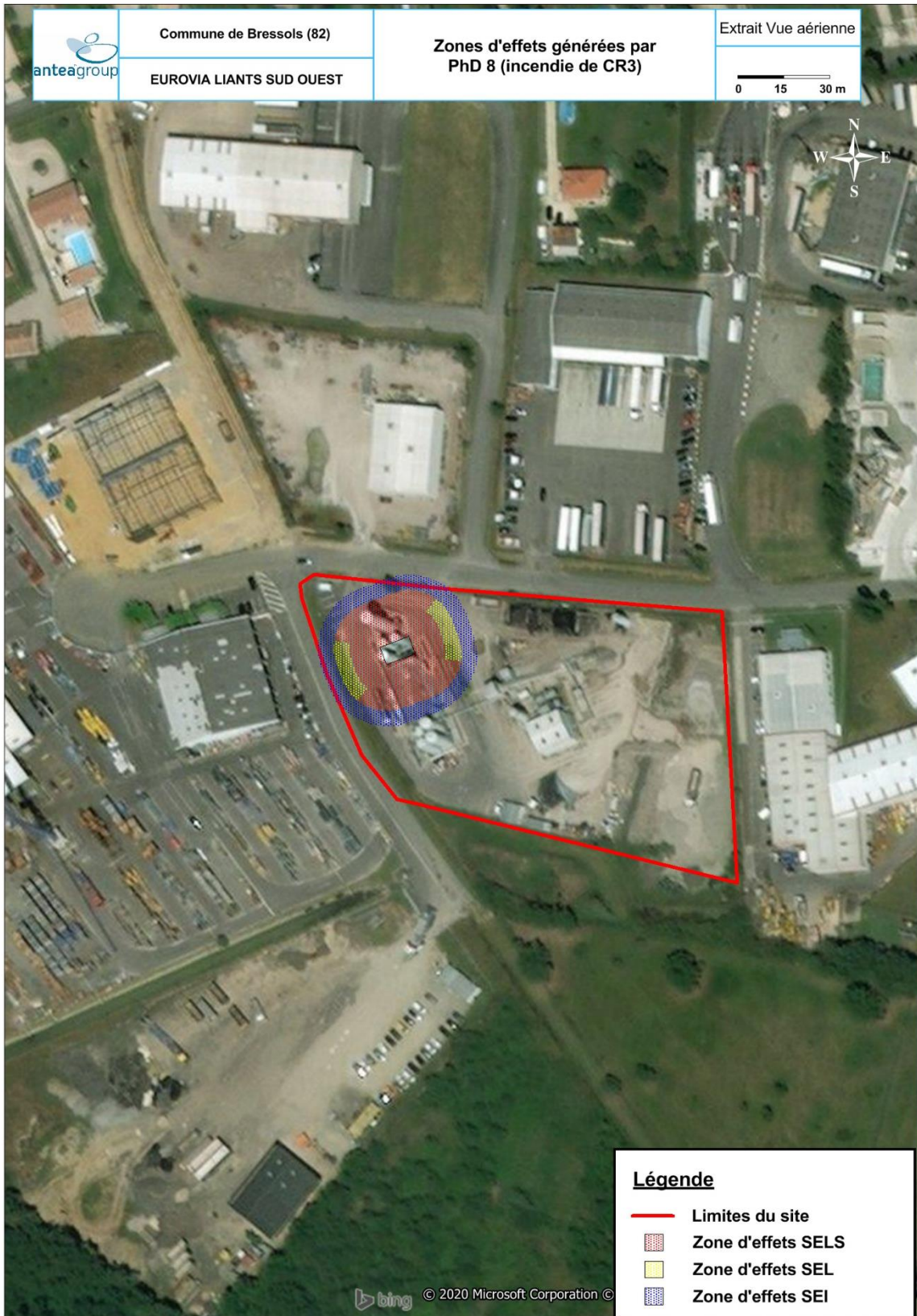
Figure 14. Cartographie des zones d'effets relatives à PhD 8 (incendie de la rétention CR3)
