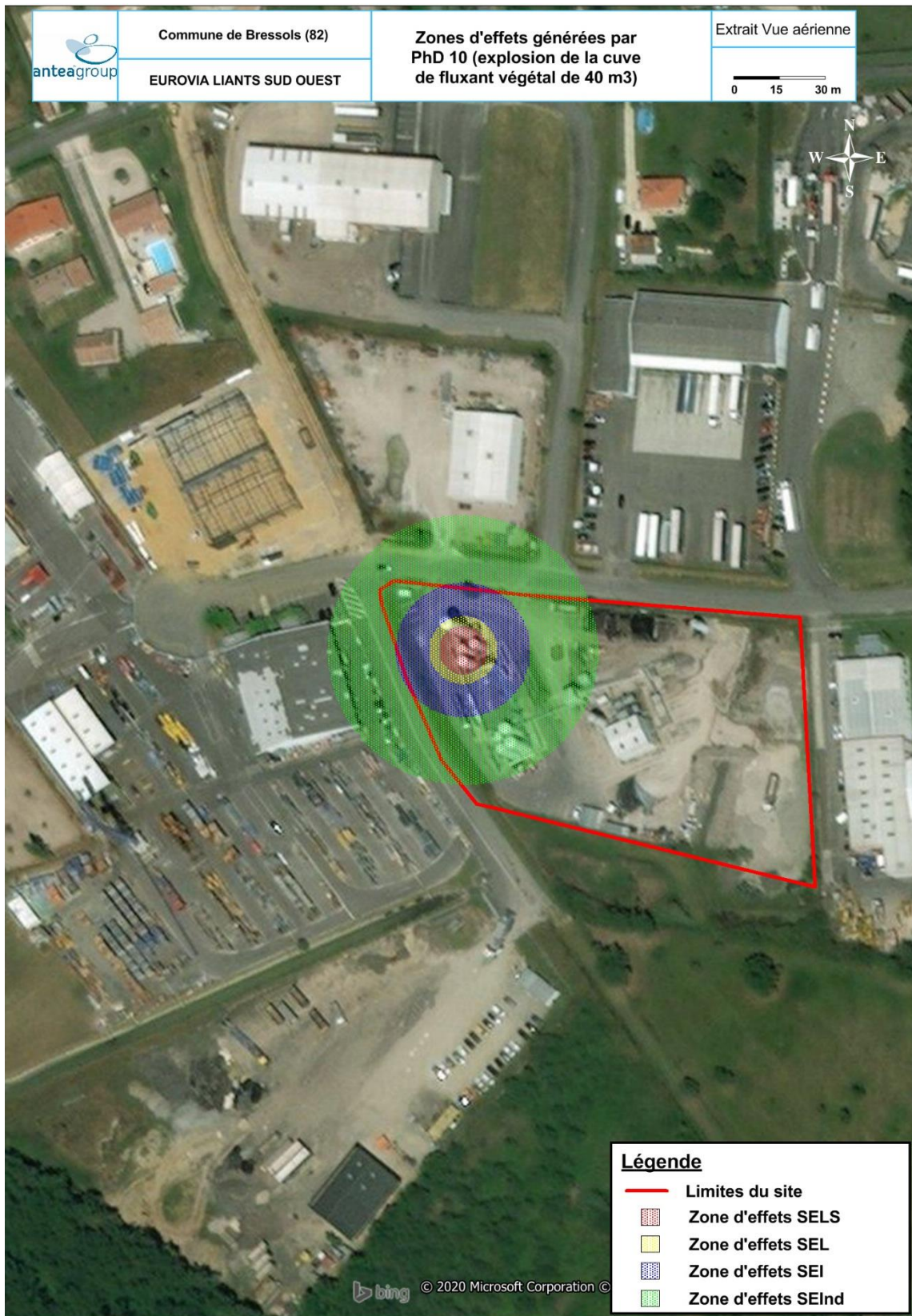
Figure 16. Cartographie des zones d'effets relatives à PhD 10 (explosion de la cuve de fluxant végétal)
